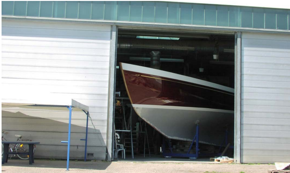
Henningsen & Steckmest: 15m Mahagoni-Projekt, gebaut mit SR5550
