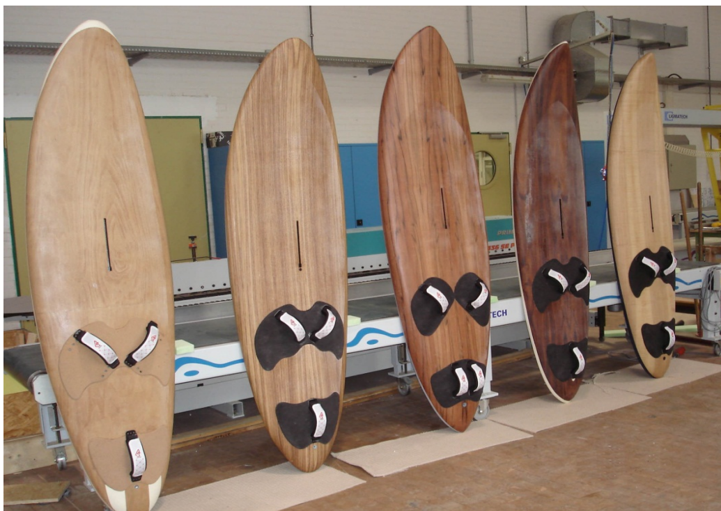
Kundenfoto: serieller Surfboardbau mittels Sandwichkern und Holzfurnieren
